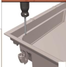
Шкафы версии РН фиксируются в перегородке поворотом крепежных винтов по часовой стрелке
